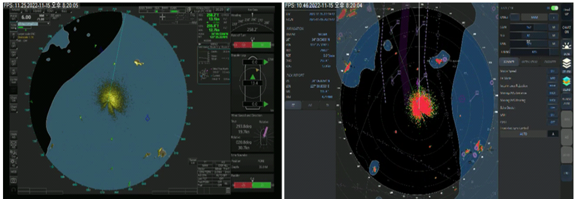
[Fig. 8] FURUNO Radar(L), Develop Radar(R) Display.
